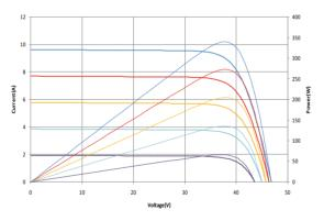
1000 W/m<sup>2</sup> 800 W/m<sup>2</sup> 600 W/m<sup>2</sup> 400 W/m<sup>2</sup> 200 W/m<sup>2</sup>
