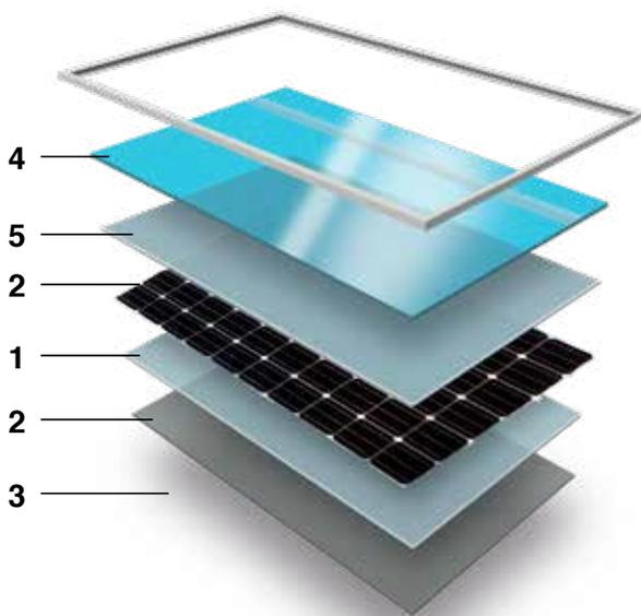
Il pannello X è costituito da 60 **celle fotovoltaiche (in classe A)** (1) in silicio monocristallino che generano in ciascun modulo una potenza elevata.
