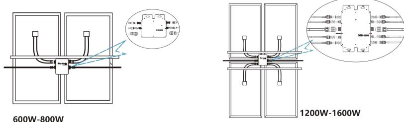
2将PV的DC连接到逆变器，注意区分正负，如下面所示：
