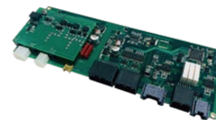
BMS バッテリー 管理システム
