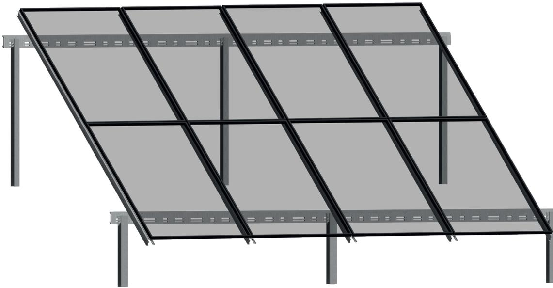
Klemmung der Module erfolgt von unten über das IROC® Evolution-Profil.
