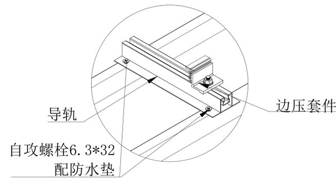
短导轨安装示意图
