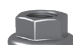
Art. 0134 Hexagon flange nuts with serration DIN 6923 M6 M8 M10 M12 Material: 1.4301 A2
