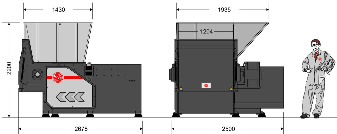
Le déchiqueteur monoarbre MR 40-120 IT est particulièrement adapté au déchiquetage de grandes quantités de déchets industriels. La lourde structure rend la machine apte à un emploi lourd et intensif. La mise en route du poussoir s'effectue au moyen d'un système hydraulique. Le produit à broyer est ainsi poussé vers un rotor porte-outils qui réalise le déchiquetage. Grâce à une grille il est possible de sélectionner la granulométrie finale du broyat.
