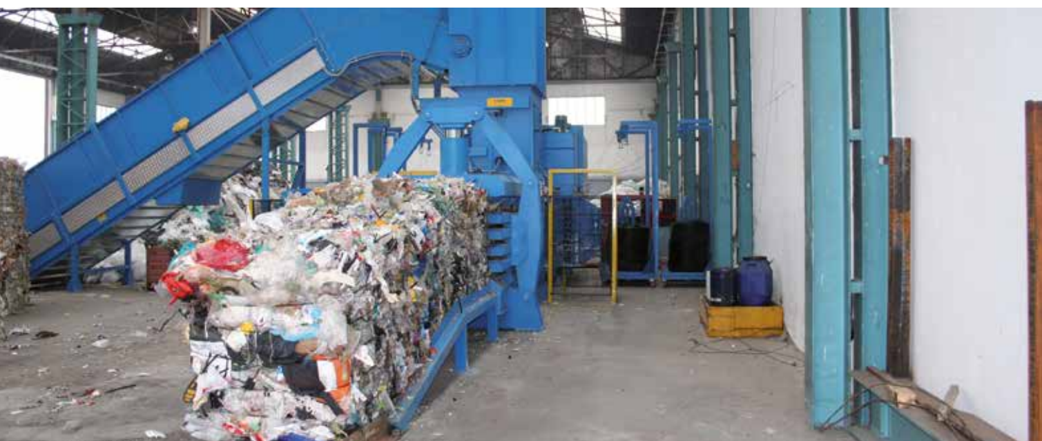
Pressa mod. PR 125 imballaggio rifiuti industriali - Baler mod. PR 125 industrial waste packaging
