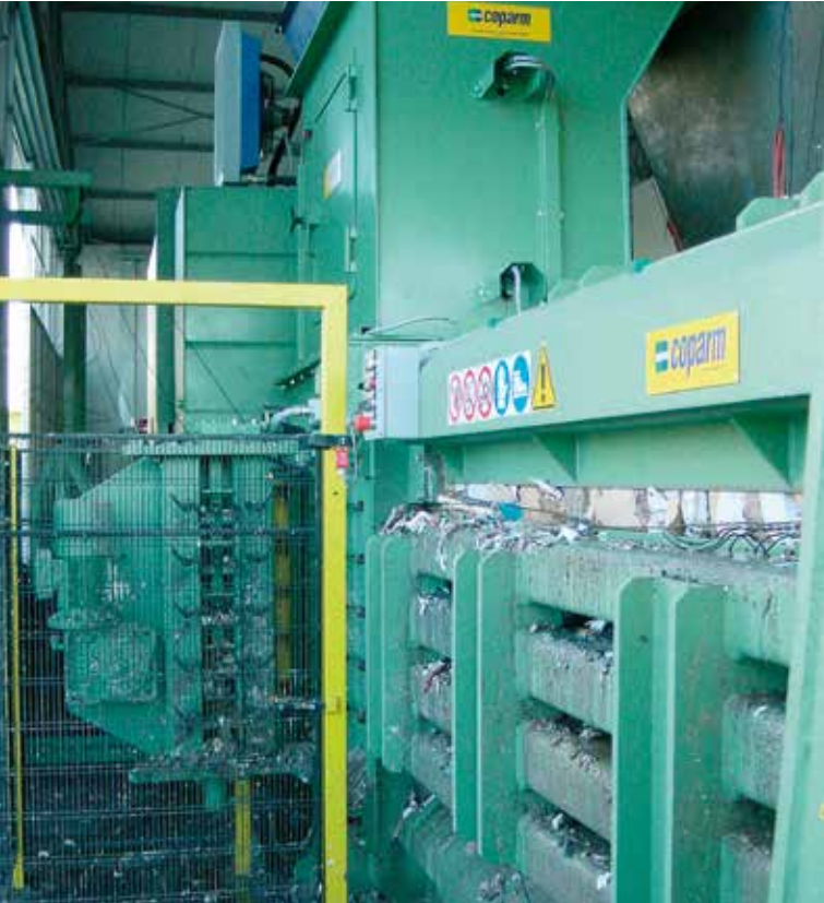
Particolare legatore automatico 5 fili - Five wires automatic binder detail
