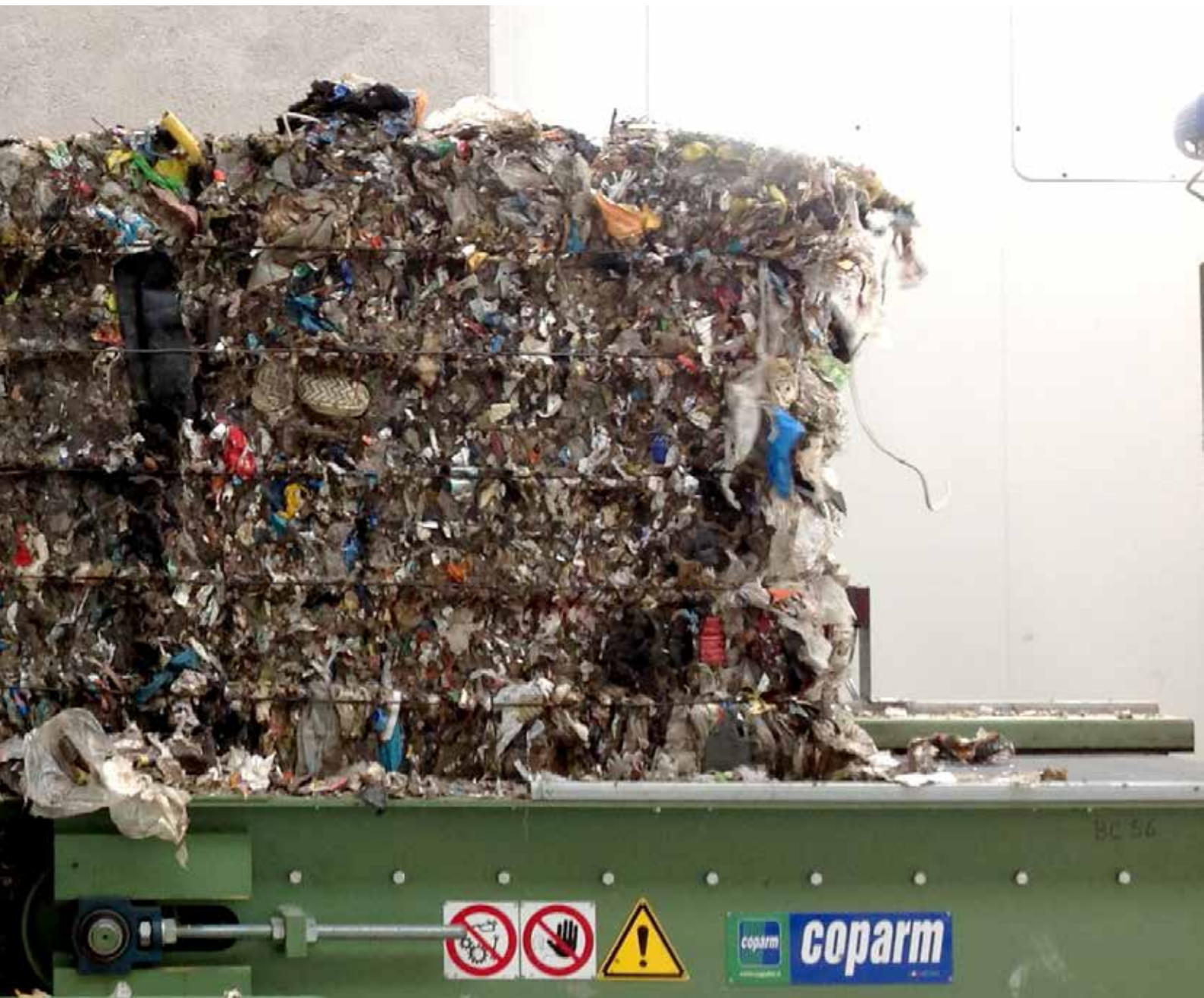
Pressa mod. PR 150 imballaggio rifiuti RSU - Baler mod. PR 150 MSW waste packaging
