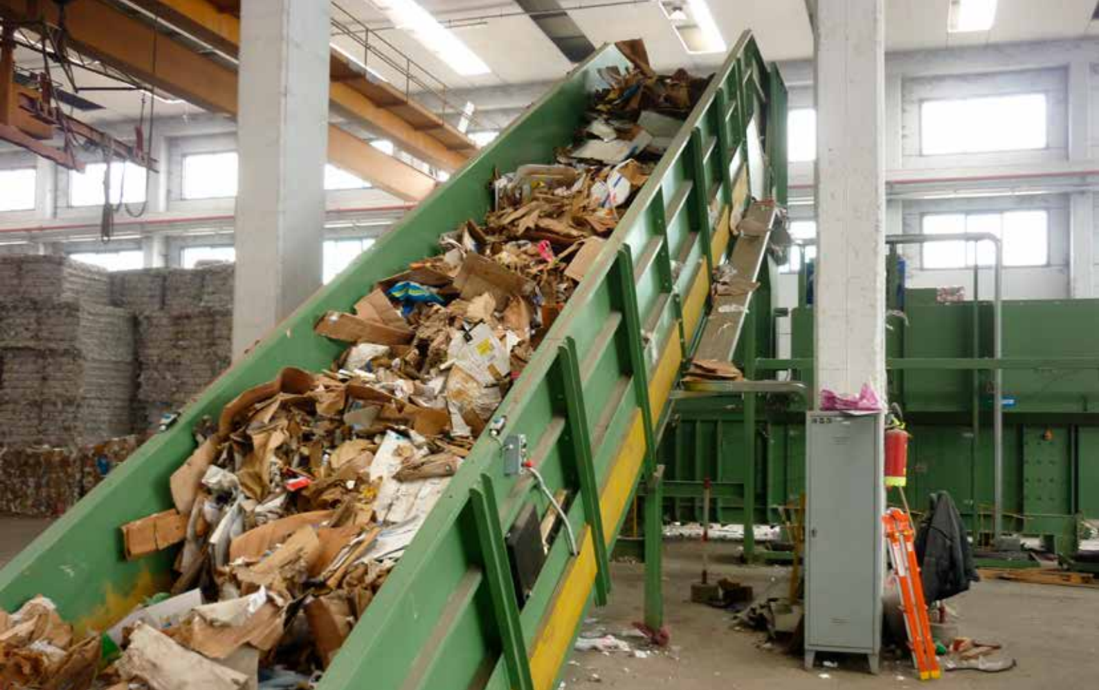
Trasportatore di alimentazione Pressa mod. TM 200_18 - Baler feeding conveyor mod. TM 200_18
