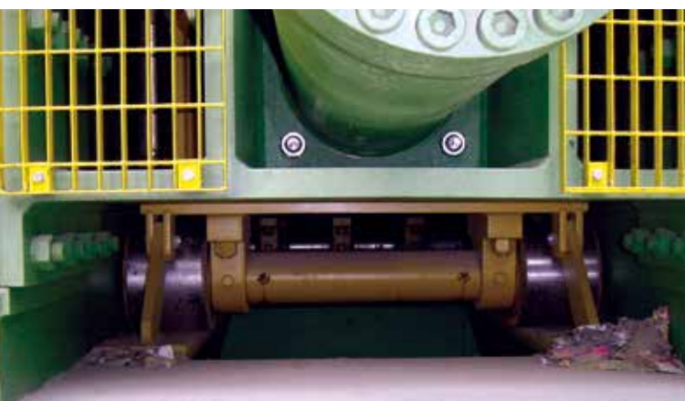
Sistema di pulizia del fondo posteriore - Back bottom cleaning system
